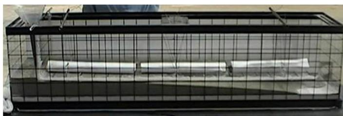
(c) 充填性確認ラボ水槽実験の様子
